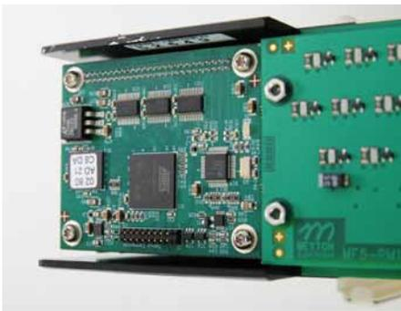
≫ 新型の測定フレームMF5R1コントローラーは、LinuxのOSの最新のシングルボードPCです。それは、命中座表を計算し、そのデータを処理部へ直接転送する事が可能です。
